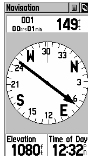
Página de Navegación (Navigation Page) con el puntero de rumbo mostrando la dirección hacia la que se está dirigiendo. La anilla de compás le proporciona información a cerca de la orientación.
