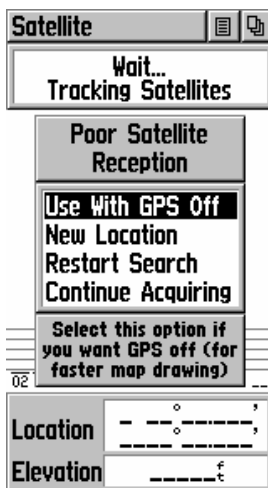
Hay cuatro opciones de iniciación para el mensaje 'Recepción pobre de satélites' (Poor Satellite Reception)
